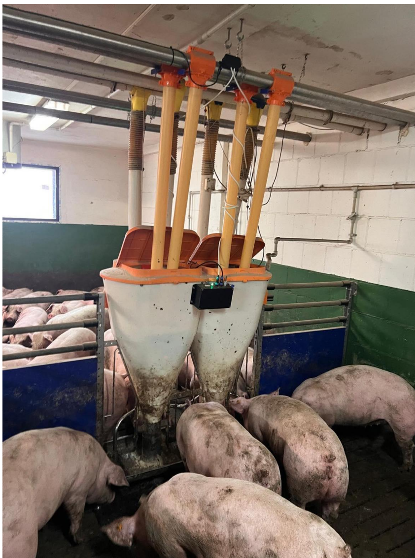
Fotografia 1. Kamera zamontowana na karmniku.
